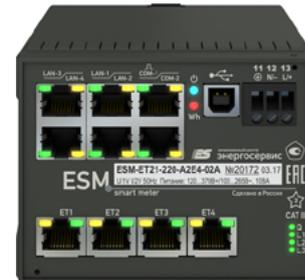
ESM с подключением к шине процесса согласно IEC 61850-9-2
